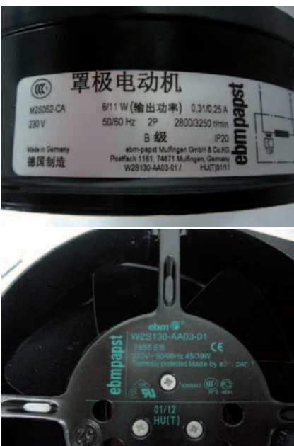
Lüfter-Fälschungen: Oberes und unteres Bild zeigen Plagiate.
